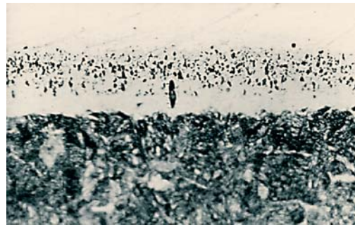
Bild 8: Wie Bild 7, jedoch zusätzlich 60 s lang mit Tonerde poliert
