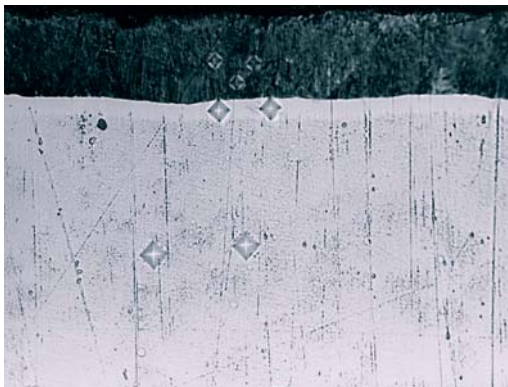
Bild 11: Randschicht des nitrocarburierten Stahls X5CrNi18-9 geätzt mit Pikrinsäure (Vergrößerung: 1000:1)
