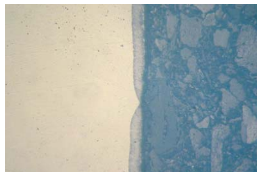
Bild 4: Ungleichmäßig ausgebildete Diffusionsschicht
