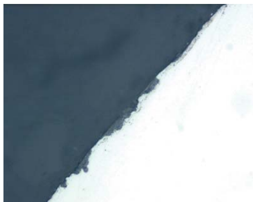
Bild 3: Reste einer Oxidschicht auf einem Federstahl.
